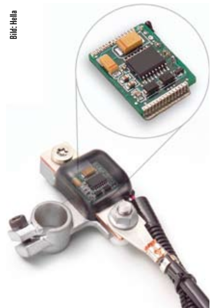
Die Auswerteelektronik für Strom, Spannung und Temperatur sitzt auf dem Batteriepol.
