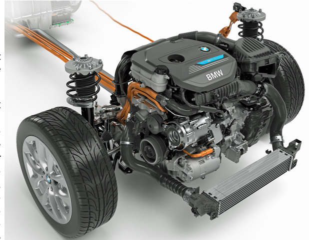
Unité de traction avant avec démarreur-générateur et compresseur de climatisation.
