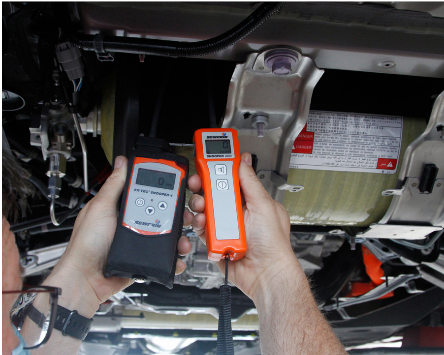
Lors de l'entretien d'un véhicule à pile à combustible, il est important de vérifier l'étanchéité du circuit d'hydrogène. Même la plus petite fuite est détectée avec des renifleurs d'hydrogène.
