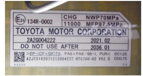
Les coûteux réservoirs composites ont une durée de vie limitée et doivent être remplacés à la fin de leur durée de vie.
