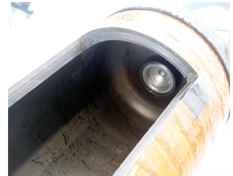
Les réservoirs composites ont une structure en couches et stockent jusqu'à 700 bar de pression.
