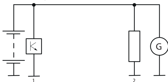
Bild 1: 12-V-Bordnetz, 1) Elektronische Bauteile 2) ohmsche Verbraucher
